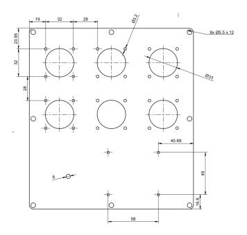
La piastra illustrata sopra sarà realizzata in alluminio e gli alloggiamenti ricavati tramite taglio laser sulla base del progetto qui descritto. Le dimensioni (22 cm circa di lato) consentono
